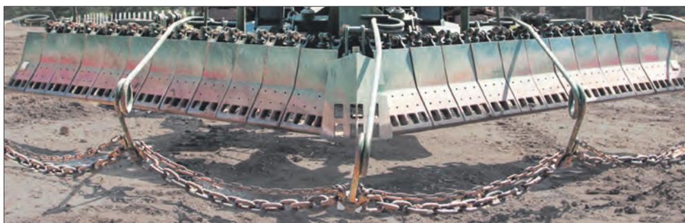
*Устройство удаления мин, установленных на грунт*
