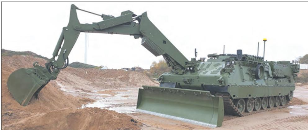
*Инженерная машина «Визент-2» при выполнении земляных работ с использованием экскаваторного ковша*
