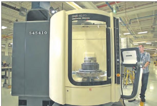
*Обработка опоры подшипника на станке с ЧПУ на заводе в г. Норт-Беруик*
