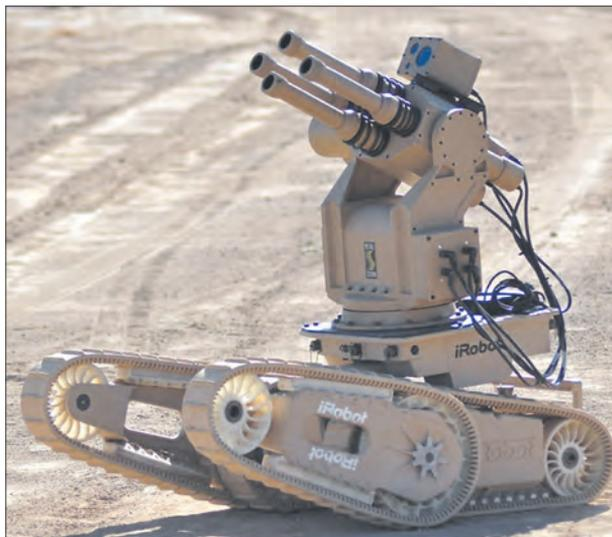
*Боевой РТК «Уорриор», разработанный американской компанией «АйРобот». Данный образец оснащен автоматическим четырехствольным 40-мм гранатометом*
