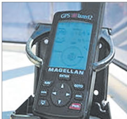
Приемник сигнала GPS
