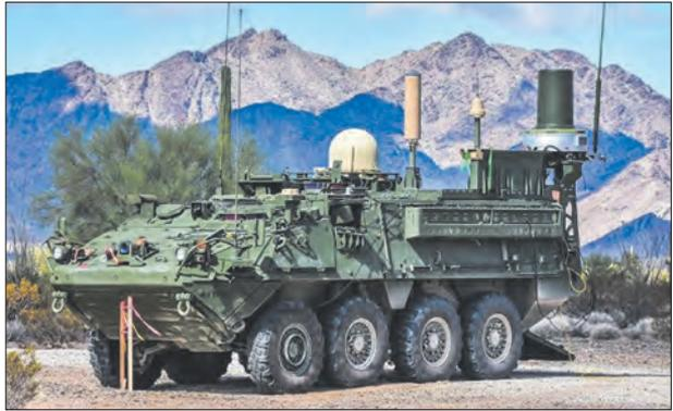
*Комплекс РЭБ бригадного уровня на базе машины M1133*
