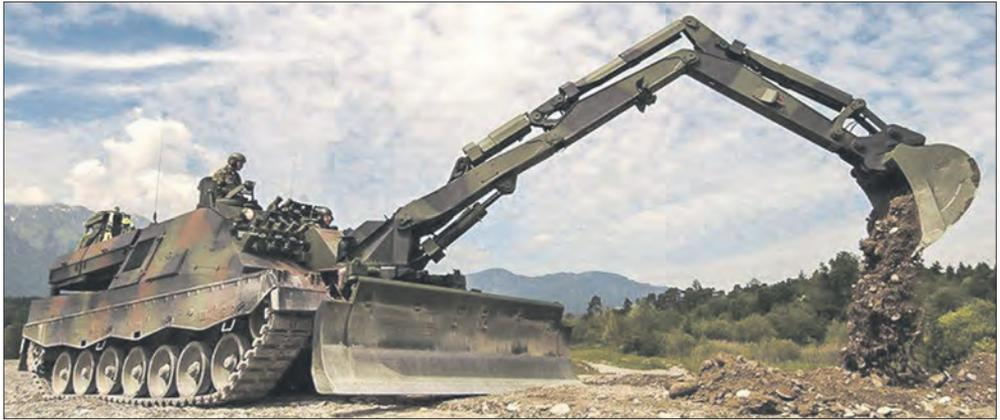
*Бронированная машина инженерного обеспечения
