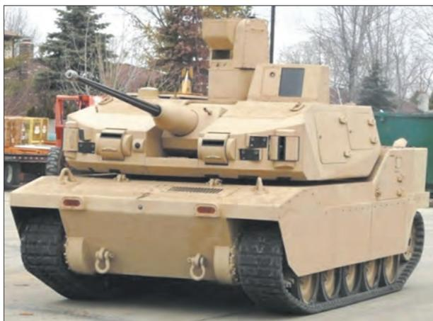
*Боевой робот «Блэк Найт» производства компании «БАэ ситемз». В зависимости от комплектации его боевая масса составляет около 9,5 т. Основное вооружение – автоматическая 30-мм пушка*
